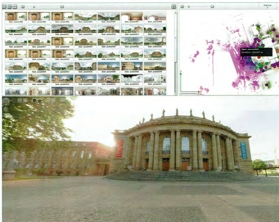
Rohdaten aus der Punktwolke: Die mit dem Scanner gelieferte Software SCENE rechnet die Scandaten für eine grafische Weiterverarbeitung in Filme, Zeichnungen, 3D-Druck oder Virtual Reality um
